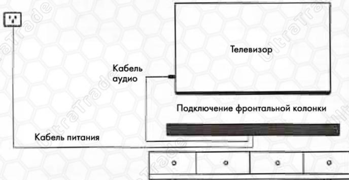
Рекомендуется использовать проводное соединение между телевизором и фронтальной колонкой (при использовании соединения Bluetooth может наблюдаться потеря или скачки в соединении)
