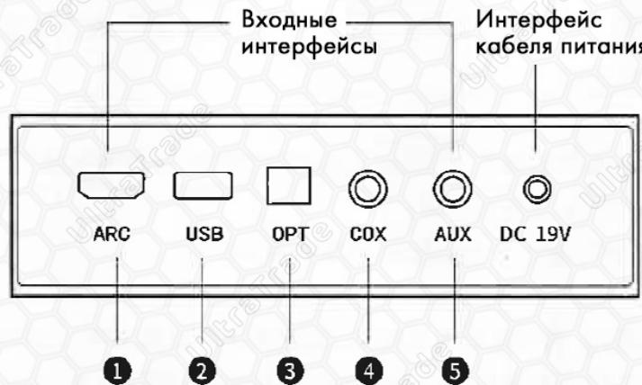
1. Входной порт ARC: Восьмиконтактный входной порт: подключите к порту HDMI (ARC) телевизора, телевизор не имеет функции шести команд. То есть, когда используется интерфейс HDMI, динамик не может быть подключен к телевизору через HDMI.
