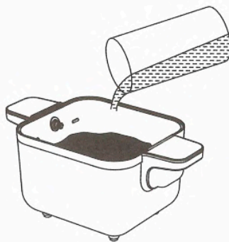
Рисунок 3 Во время приготовления на пару снимите лопатку для перемешивания и добавьте чистую воду.
