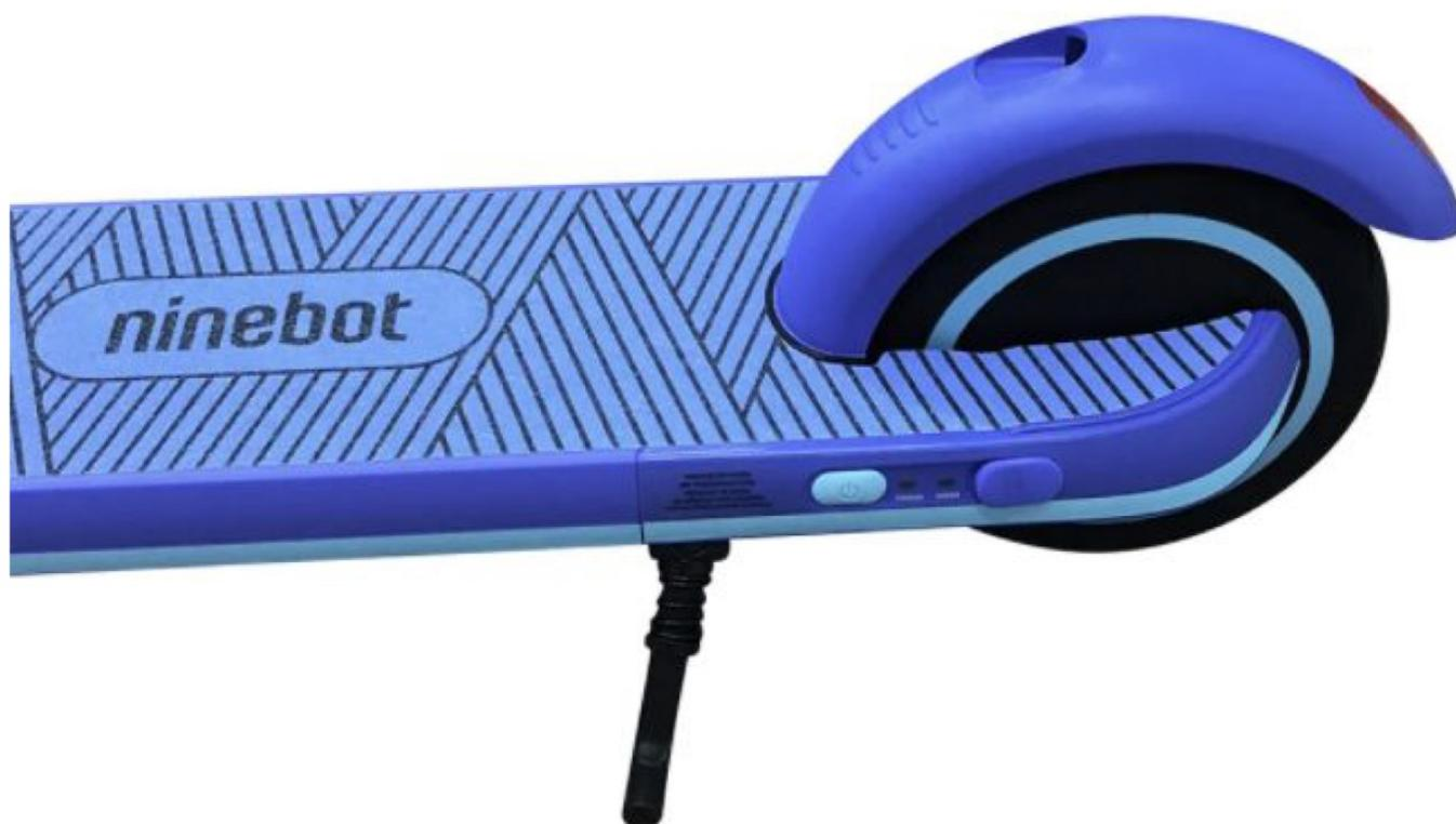
Рядом с разъемом расположен индикатор уровня заряда аккумулятора.
