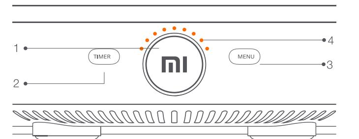
1. Регулятор переключения программ / ЖК-дисплей (Program selection switch / LCD display)
