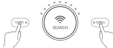
Если устройству не удается подключиться к Вашему смартфону, одновременно нажмите и удерживайте кнопки «Функции» и «Таймер» в течение 5 секунд, чтобы выполнить сброс подключения. При успешном сбросе подключения начнет мерцать желтый световой индикатор. Вы можете повторно подключиться к сети.
