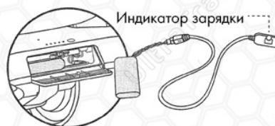
Продукт имеет конструкцию защиты от перегрева. Если температура корпуса  $40^{\circ}\text{C}$ , продукт не сможет нормально заряжаться, подождите, пока корпус остынет до температуры ниже  $40^{\circ}\text{C}$ , перед зарядкой.
