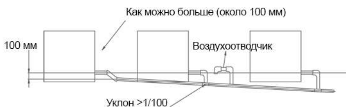
Способ подключения централизованного дренажа
