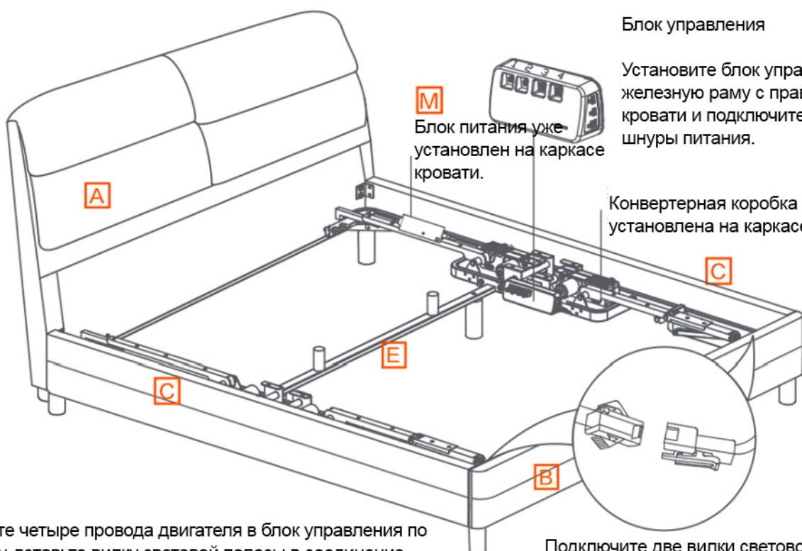
Вставьте четыре провода двигателя в блок управления по порядку, вставьте вилку световой полосы в соединение между боковой и нижней частью кровати, вставьте вилку преобразовательного блока рядом с двигателем № 3 в разъем-гнездо световой подсказки на правой стороне блока управления (среднее положение).
