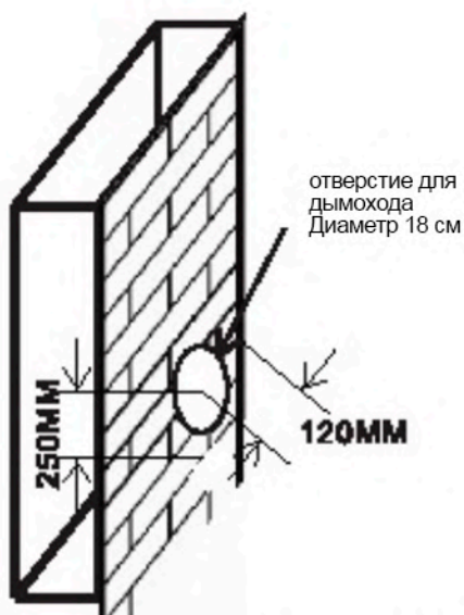
Стандартное положение открытия стенки дымохода
