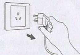
Перед обслуживанием, чисткой или ремонтом стиральной машины, пожалуйста, выньте вилку из розетки. Не подключайте и не вынимайте вилку из розетки мокрыми руками, это может привести к поражению электрическим током.
