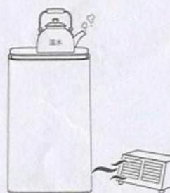
Не кладите никакие нагревательные или тяжелые предметы на стиральную машину(например такие, как чайник, фен, нагреватель). Избегайте других посторонних источников нагревания, не ставьте стиральную машину под прямыми солнечными лучами или вблизи батареи, нагревателя или газовой плиты.
