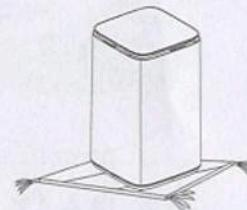
Стиральную машину нельзя устанавливать на ковровые покрытия, которые способны блокировать вентиляционные отверстия. Убедитесь, что после установки дно стиральной машины хорошо вентилируется.
