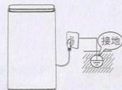
Для безопасного использования убедитесь в том, что подключаемое гнездо надежно. Что оно правильно установлено, закреплено и имеет заземление. Рекомендуется использовать средство защиты от протечек.
