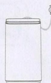
Для подключения водоподачи используйте единоличное(не совмещенное с другими) подключение к впускной трубе. Не подключайте водоподачу к источнику горячей воды. Регулярно проверяйте на предмет расширения или перекручивания шланга. Обращайте внимание на износ или протечку воды. Своевременно устраните проблему. Свяжитесь со службой технической поддержки, и не пользуйтесь стиральной машиной до устранения проблемы.
